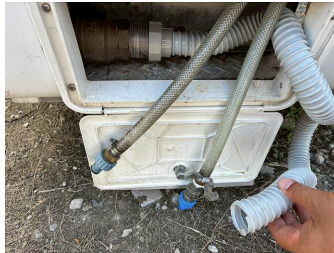
給排水口 + 直結ホース
